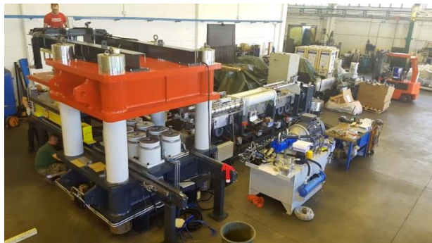
Foto 2 – Linea prototipo di stampaggio di pallet in plastica eterogenea da scarto (foto: Selene S.p.A.)
