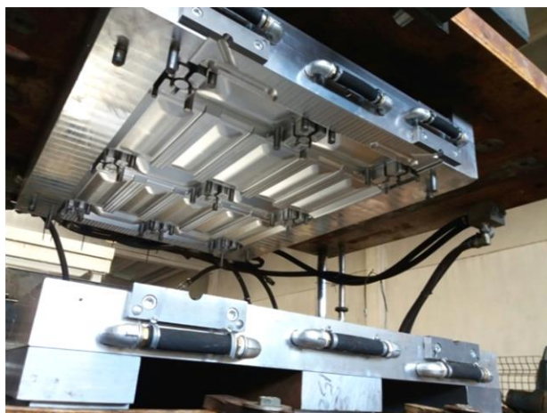
Foto 3 – Stampo del pianale dell'euro-pallet in plastica mista da scarto di pulper (foto: Selene S.p.A)
