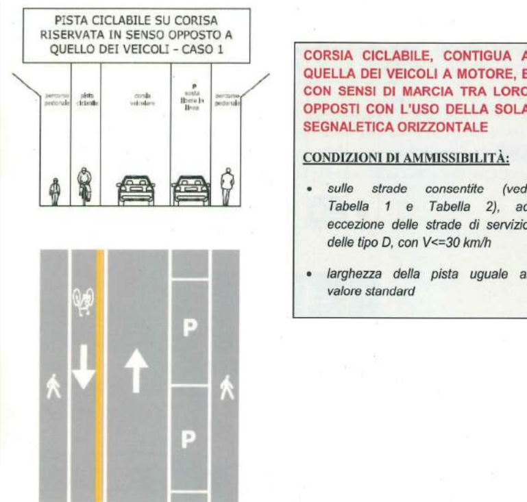
Figura 11: pista ciclabile su corsia riservata in carreggiata di verso discorde a quello della contigua corsia destinata ai veicoli a motore e con l'uso della sola segnaletica orizzontale
