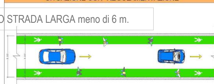
SCHEMA "TIPO" CIRCOLAZIONE SU STRADE CON LARGHEZZA 5.00 m. SITUAZIONE CON REGOLAMENTAZIONE
