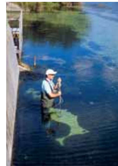
Misura delle portate con mulinello idrometrico
